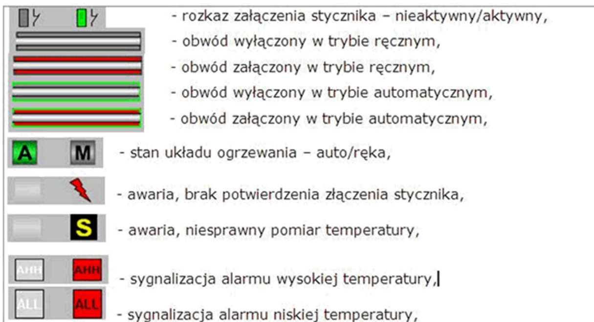
Rysunek 10 Legenda stacyjki obwodu grzewczego
